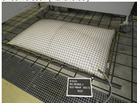
Abbildung 6 Festigkeit der Befestigungseinrichtung Nachweisversuch (Randkordel)
