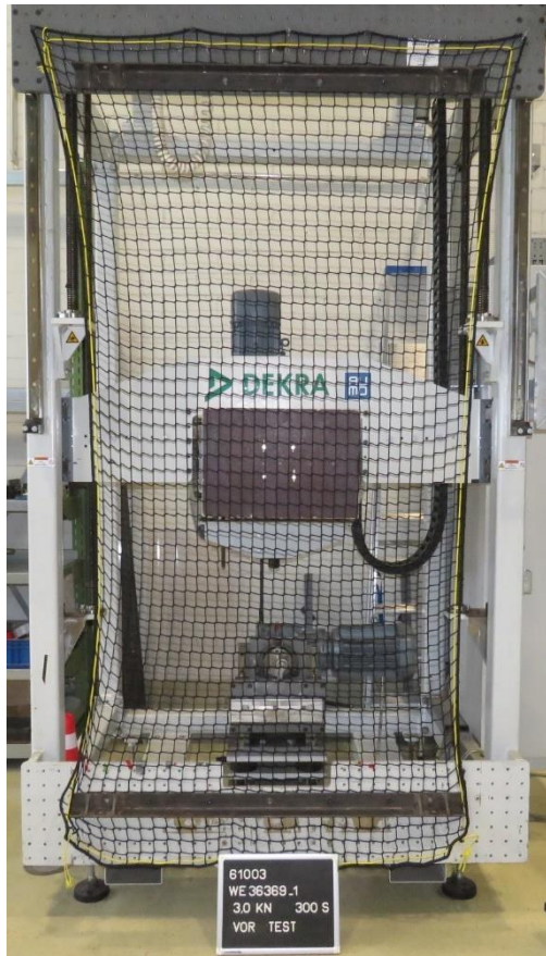
Abbildung 10 Festigkeit des Netzes (Maschenfestigkeit) Nachweisversuch vor Test
