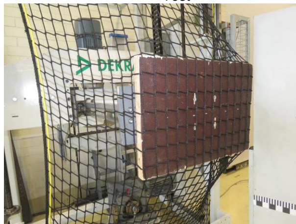
Abbildung 12 Detailansicht Festigkeit des Netzes (Maschenfestigkeit) Nachweisversuch
