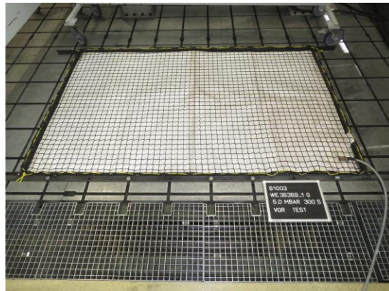
Abbildung 7 Festigkeit der Befestigungseinrichtung (Expanderseil)
