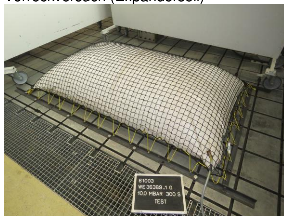
Abbildung 9 Festigkeit der Befestigungseinrichtung Nachweisversuch
