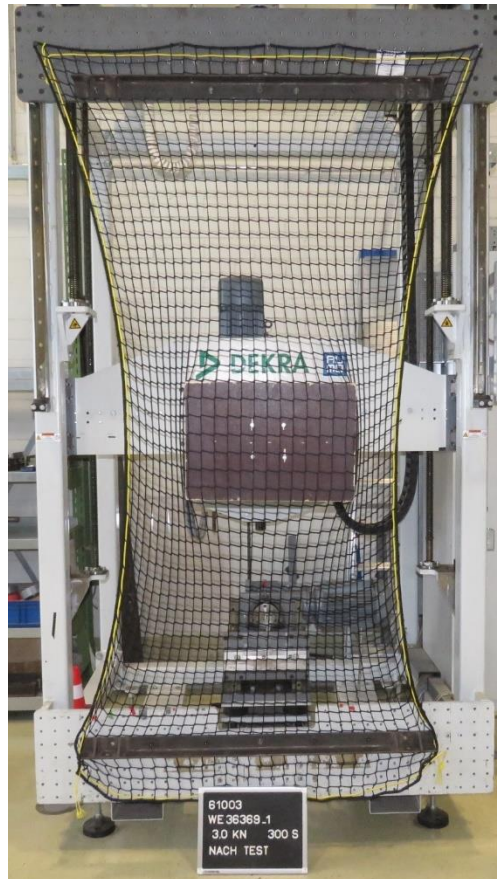
Abbildung 11 Festigkeit des Netzes (Maschenfestigkeit) Nachweisversuch nach Test
