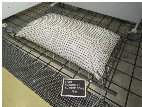
Abbildung 8 Festigkeit der Befestigungseinrichtung Vorreckversuch (Expanderseil)
