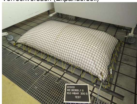
Abbildung 9 Festigkeit der Befestigungseinrichtung Nachweisversuch
