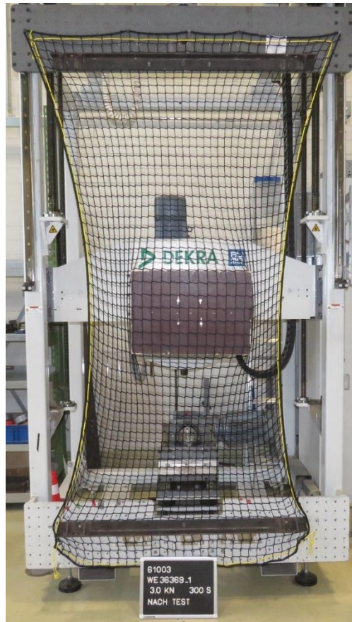
Abbildung 11 Festigkeit des Netzes (Maschenfestigkeit) Nachweisversuch nach Test
