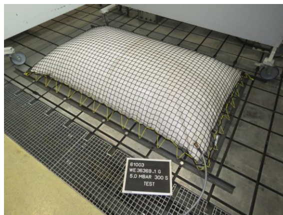
Abbildung 8 Festigkeit der Befestigungseinrichtung Vorreckversuch (Expanderseil)
