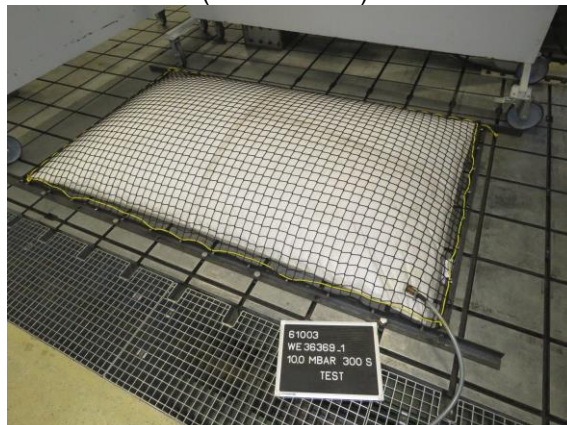
Abbildung 6 Festigkeit der Befestigungseinrichtung Nachweisversuch (Randkordel)
