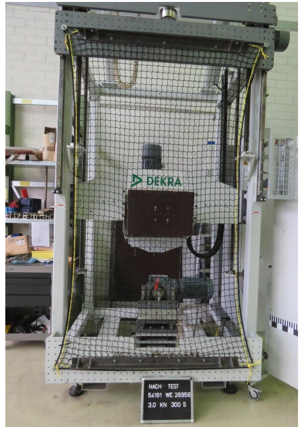
Abbildung 11 Festigkeit des Netzes (Maschenfestigkeit) Nachweisversuch nach Test
