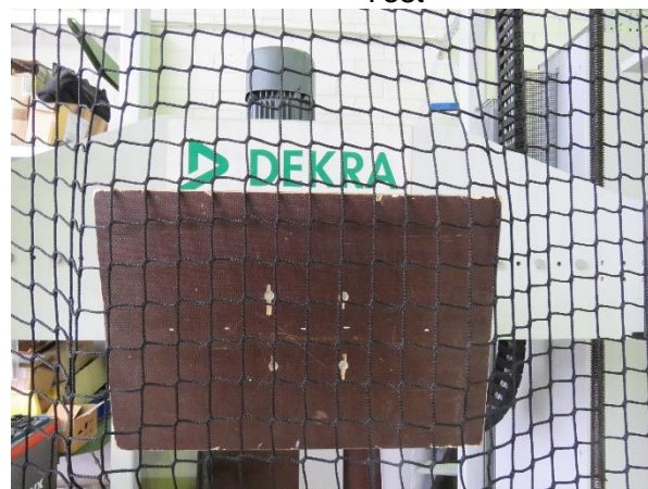
Abbildung 12 Detailansicht Festigkeit des Netzes (Maschenfestigkeit) Nachweisversuch nach Test
