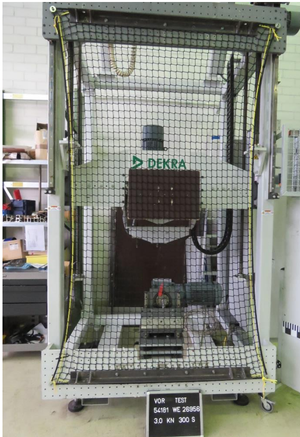
Abbildung 10 Festigkeit des Netzes (Maschenfestigkeit) Nachweisversuch vor Test
