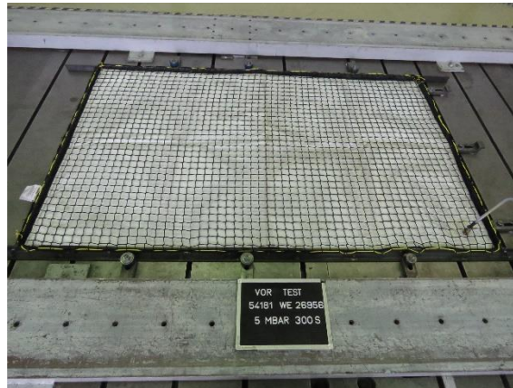
Abbildung 7 Festigkeit der Befestigungseinrichtung (Expanderseil)
