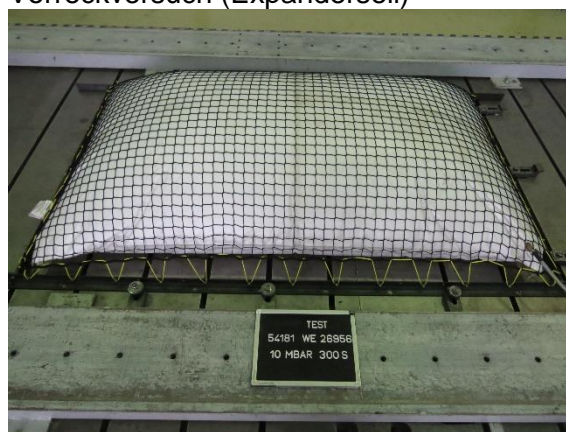
Abbildung 9 Festigkeit der Befestigungseinrichtung Nachweisversuch
